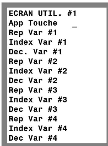
Utiliser [↑] / [↓] pour se déplacer dans le menu. Dans 'App Touche' saisir la séquence d'appuis de touches (jusqu'à 4 touches) utilisée pour appeler cet écran. Les touches sont identifiées par les lettres A à Z.
